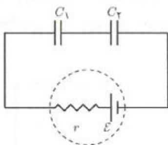
در مدار نشان داده شده در شکل  $\epsilon$ ،  $r$  و  $C_1$  مقادیر ثابتی هستند. با تغییر  $C_2$  انرژی ذخیره شده در خازن ۲، که آن را با  $U_2$  نشان می‌دهیم، تغییر می‌کند. نمودار  $U_2$  بر حسب  $C_2$  کدام است؟
