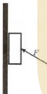
کتابی به جرم  $2$  kg را با نیروی  $F$  به دیوار قائمی فشار می‌دهیم به طوری که کتاب نه به پایین و نه به بالا می‌لغزد. ضریب اصطکاک ایستایی بین کتاب و دیوار  $0.75$  و شتاب گرانش  $10 \text{ m/s}^2$  است. کم‌ترین مقدار نیروی  $F$  چند نیوتن است؟
